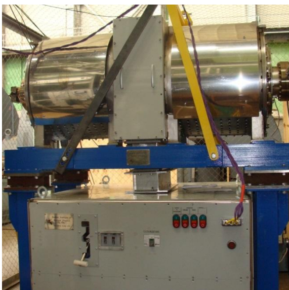
Рис. 3.6.6. ВЧ станция на испытательном стенде
