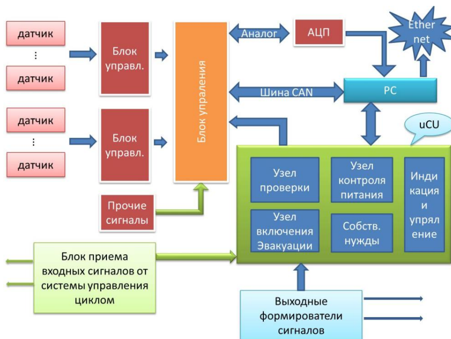
Рис. 5.3.13. Блок схема узлов системы защит
