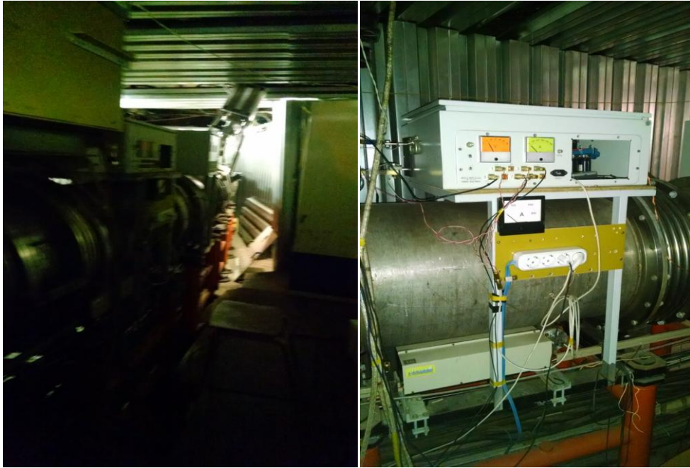
Рис. 5.6.2. Общий вид ускорительной станции на кольце Нуклотрона (слева), усилитель подмагничивания ферритов с источником питания (справа)
